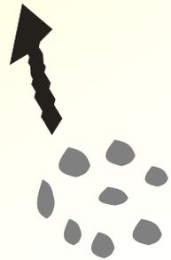
Grobe Flugaschen werden vom Brennstoffbett mit dem Rauchgas ausgetragen und zum Teil im Feuerraum bzw. Kessel wieder abgeschieden
