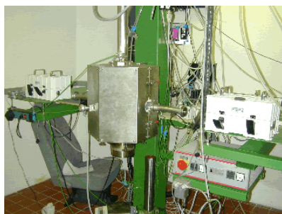
Reaktor mit Regelungstechnik und FT-IR Heißgasmessapparatur
