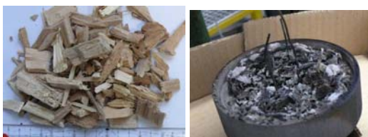
Brennstoff und Rückstände (Aschen) bei einem Testlauf mit Buchen-Hackgut
