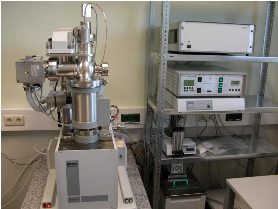
Hochtemperatur Simultan-Thermo-Analysen-Apparatur mit Massenspektrometer
