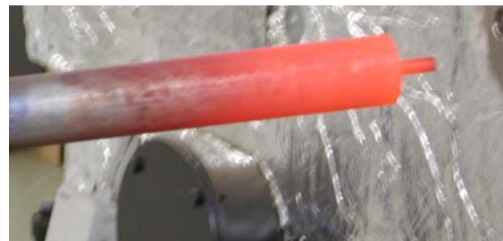
Der Hochtemperatur-Impaktor unmittelbar nach erfolgter Probenahme
