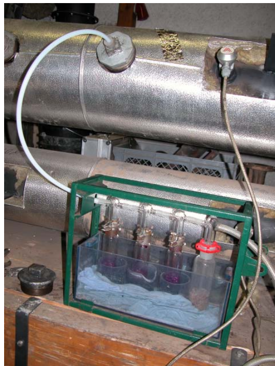
Gasentnahme und Gaswäsche zur Bestimmung der Konzentrationen an SO x , HCl, NH 3 , Hg und gasförmigen Schwermetallen im Rauchgas
