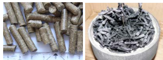
Brennstoff und Rückstände (Aschen) bei einem Testlauf mit Strohpellets
