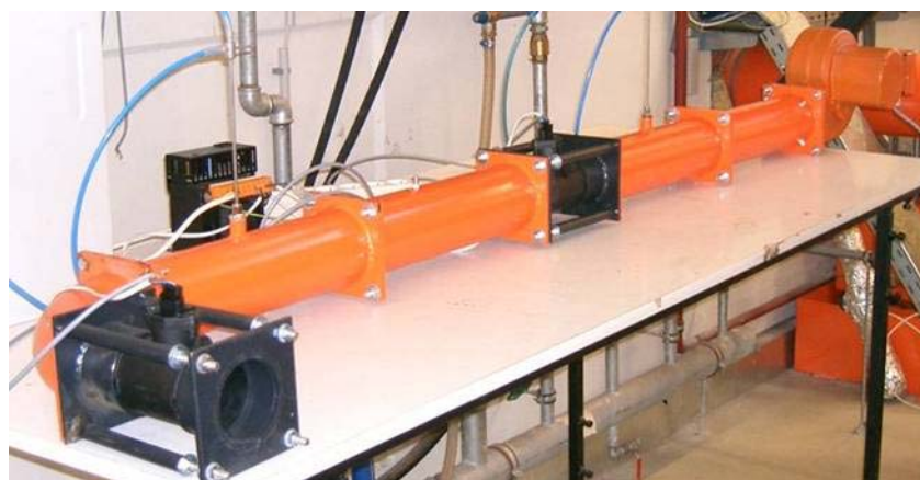
Teststrecke zur Ermittlung der Messgenauigkeit unterschiedlicher Sensoren zur Bestimmung von Luft- und Rauchgasvolumenströmen
