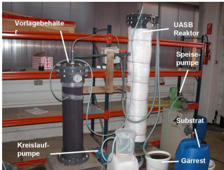
UASB Pilotanlage (UASB: upflow anaerobic sludge blanket)
